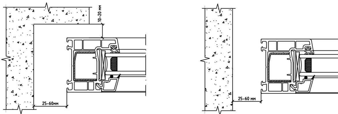
б) Оконные блоки из профиля окрашенного в массе при длине стороны от 2000 до 3500 мм.
