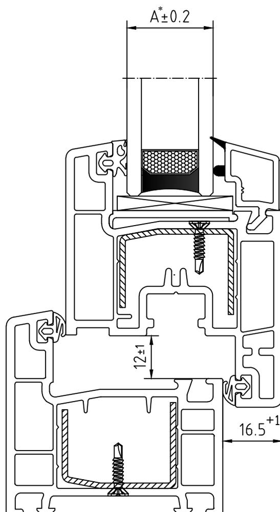
\* - A (толщина заполнения): от 4 мм до 34 мм
