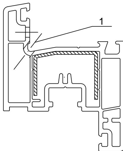
1 - Отверстия изготавливаются только на вертикальных частях створки (с боков)..
