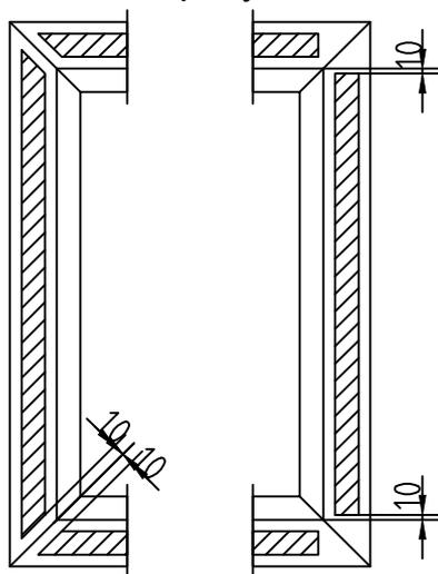
Не допускается стыковка или разрыв армирования по длине в пределах одного ПВХ-профиля.
