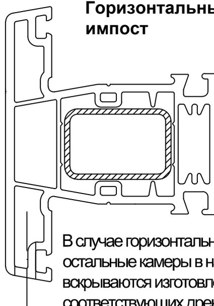
В случае горизонтального импоста остальные камеры в наплавах импоста вскрываются изготовлением соответствующих дренажных отверстий.
