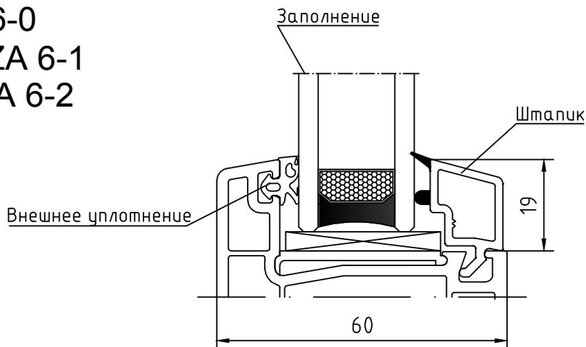
Таблица остекления для штапиков с коэкструдированным и впрессованным уплотнением
