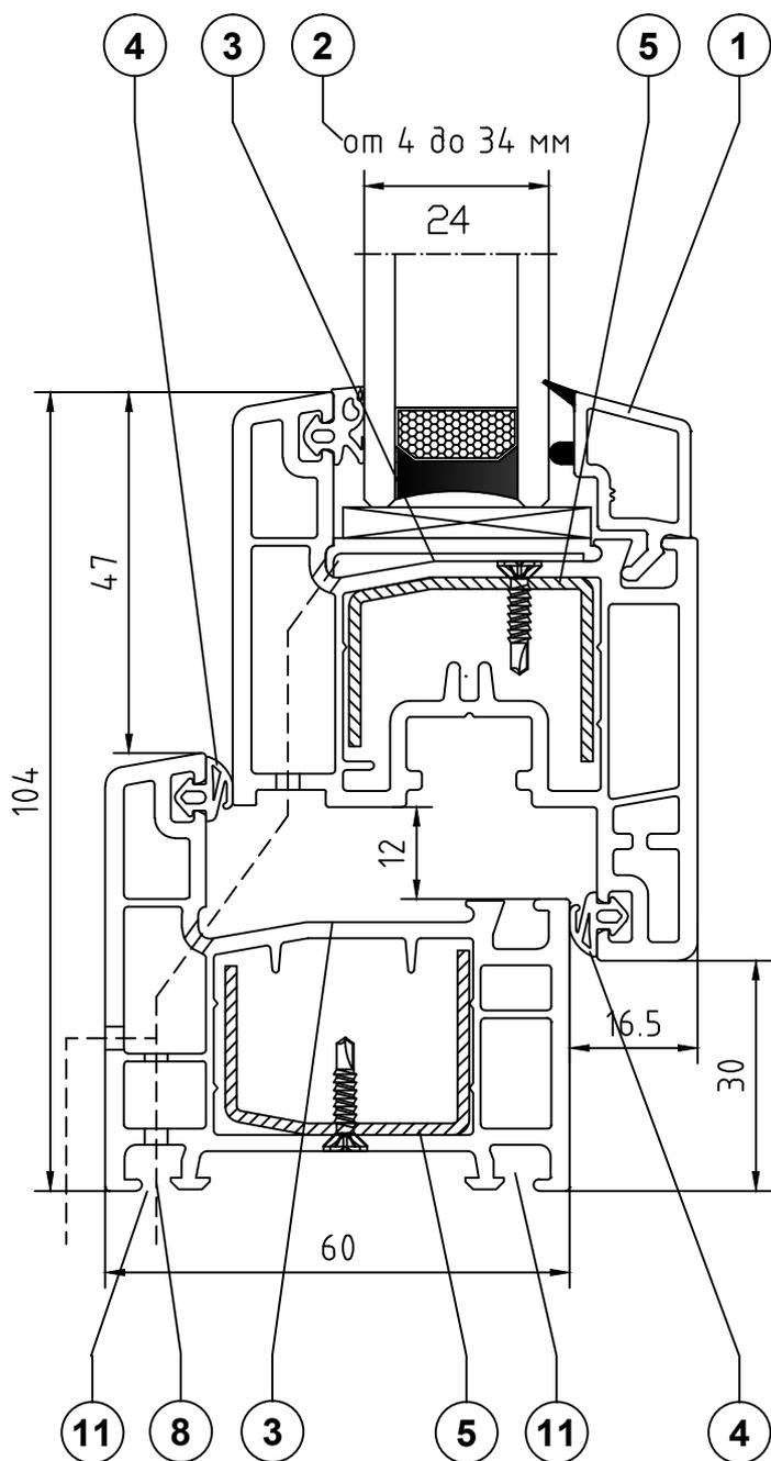
1. Штапик с коэкструдированным, впрессованным или вставным уплотнителем.
