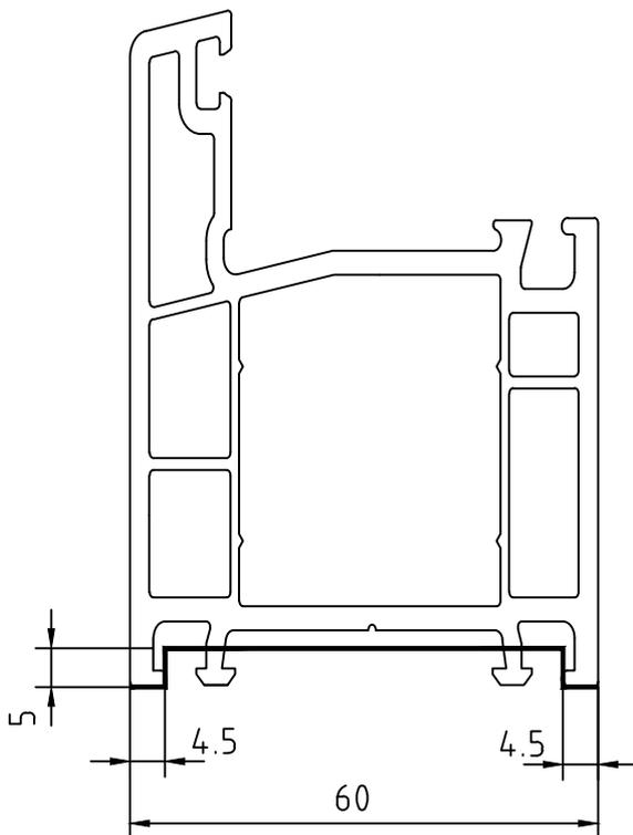
**Конфигурация кромки фрезы для зачистки створки**
