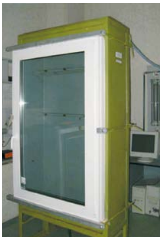
Фото 3. Общий вид оконного блока в камере для испытания воздухопроницаемости
